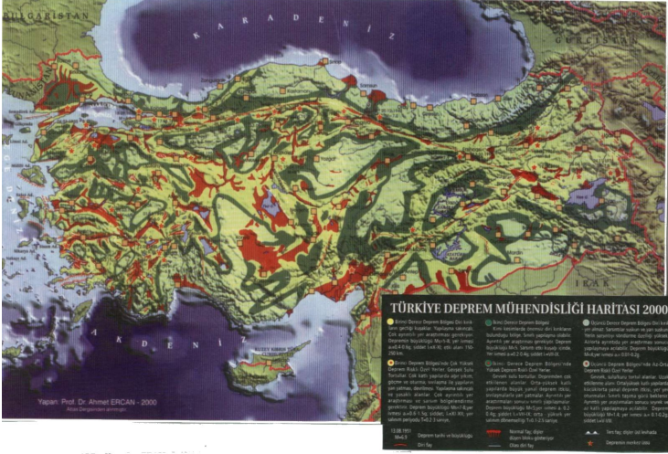
Görüntü 17- Türkiye'de oluşacak depremlerin nereleri, ne ölçüde etkileyeceğini gösteren; deprem mühendislik haritası (66).
